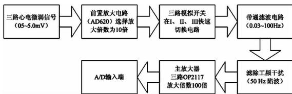
图 2 心电信号调理电路框图
